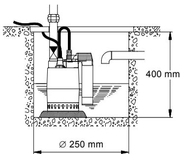
Obr. 3 Min. rozměry nádrže pro Unilift KP-AV
