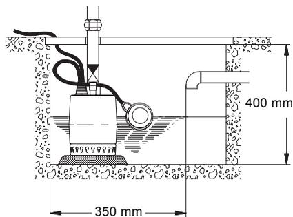
Obr. 2 Min. rozměry šachty pro Unilift KP-A
