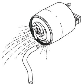
**Obr. 12** Propláchnutí čerpadla
