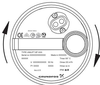
Obr. 9 Směr otáčení
