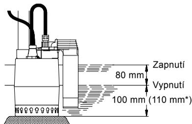
Fig. 7 Zapínací/vypínací hladiny KP-AV
