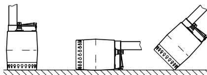
Obr. 4 Umístění Unilift KP-A a Unilift KP-M
