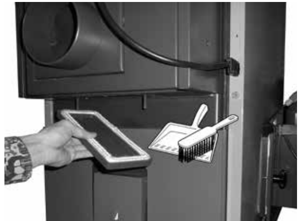
Ukážka čistenie dymového kanála v zadnej časti kotla
