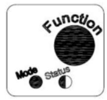
1. Po pripojení napájacieho napäťia sa rozsvieti kontrolka MODE a STATUS svieti ak čerpadlo beží. Ak status bliká došlo k chybe čerpadla alebo chodu na sucho. Pri prvom spustení treba počkať, kým nezačne vytokať z potrubia voda, ak zasiahne ochrana proti chodu na sucho pred tým ako začne tiecť voda (STATUS BLIKÁ), tak sa čerpadlo dá zapnúť trvalým stlačením tlačidla FUNCTION.
